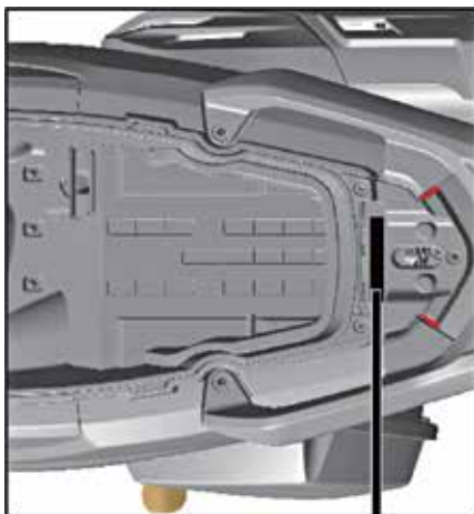
Αριθμός πλαισίου οχήματος (VIN)
